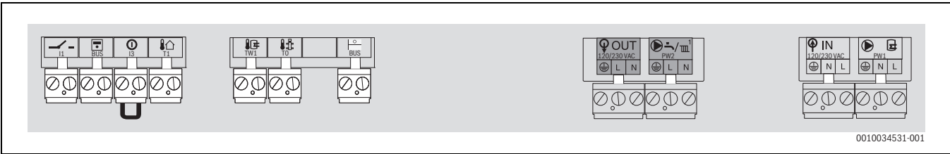
Fig. 23 Vista geral do bloco de terminais
